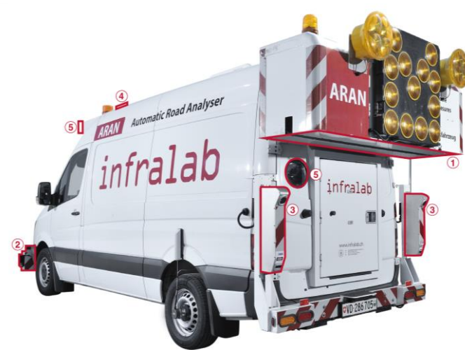
Le bus ARAN et ses multiples capteurs (Infralab)
