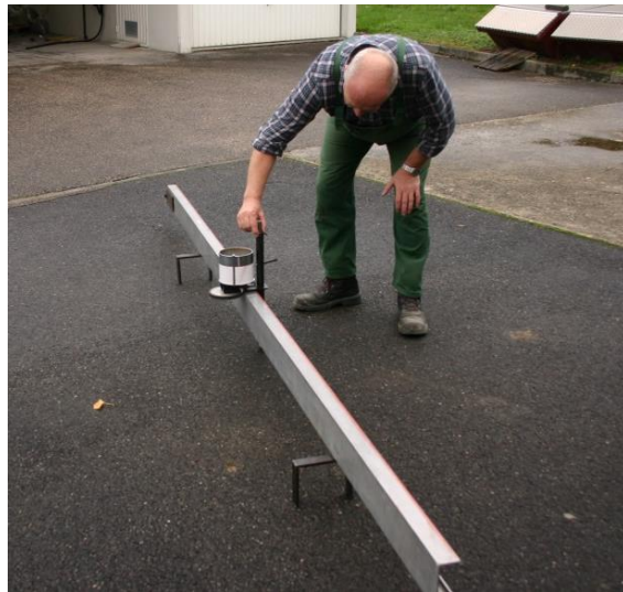
Mesure de profils en travers avec une barre de 4 m (CCDR)
