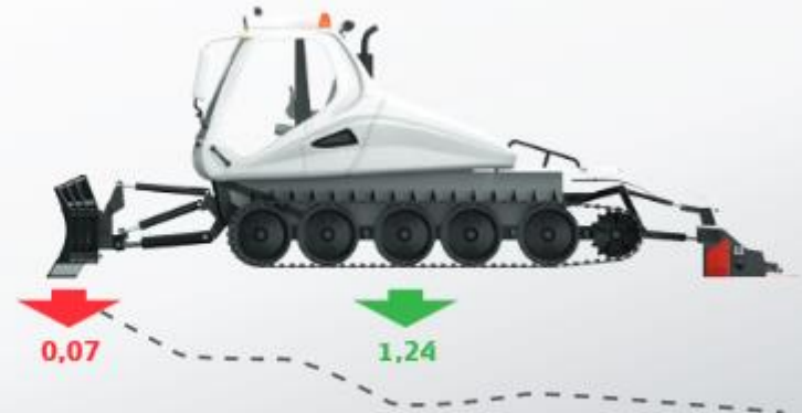
Anzeige der aktuellen Schneehöhe auf dem Maschinendisplay erlaubt autonomes Arbeiten
