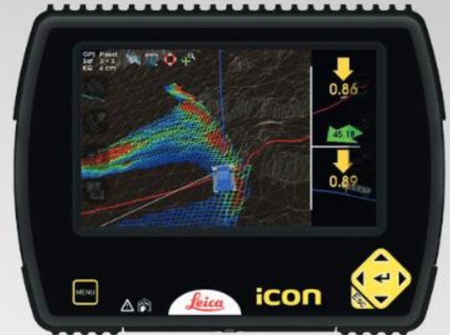
Anzeige der aktuellen Schneehöhe auf dem Maschinendisplay erlaubt autonomes Arbeiten
