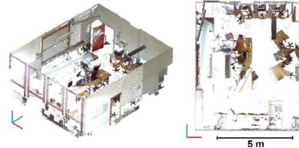
Nuage de points d'une pièce après extraction du sol et du plafond
