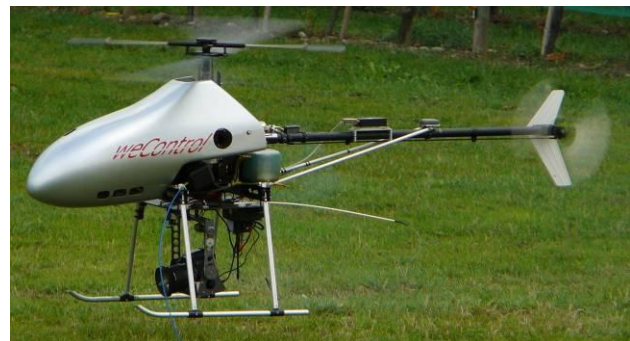
Figure 2: Mini UAV of weControl (Zurich) with the RGB sensor Canon EOS 20D.
