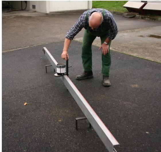
*Profilmessung quer mit einem 4 m langen Stab (CCDR)*
