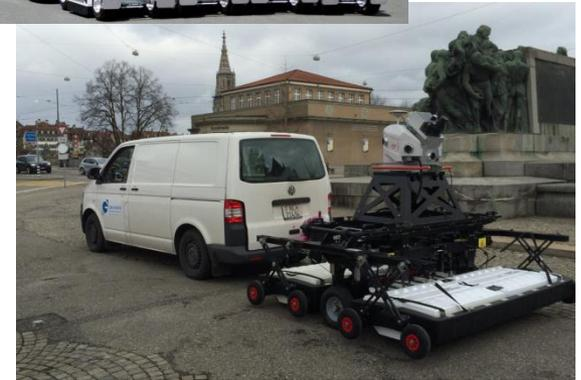
Anhänger, ggf. kombiniert mit GNSS, Mobile Scanning/Mapping
